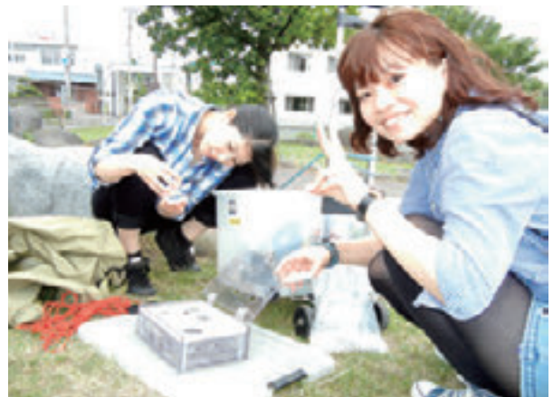
現場でのパッシブサンプラー設置の様子
