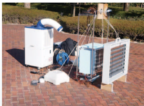
写真3 外付けブラインドの日射遮蔽効果の検証実験
