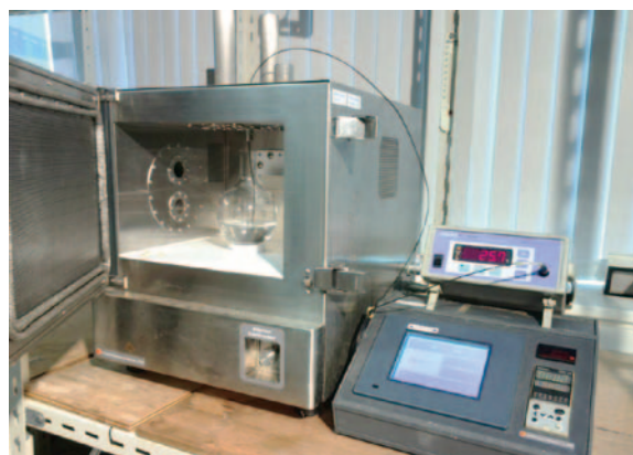
図3 液体にマイクロ波を照射して活性化する装置
