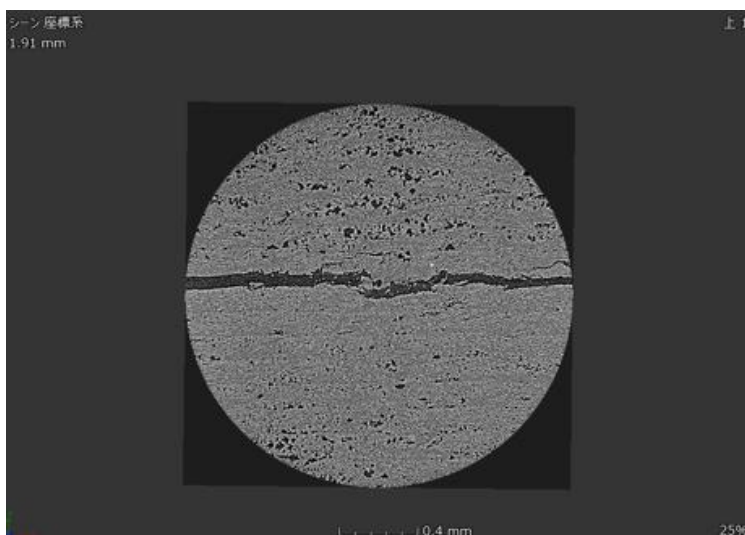
図2 き裂部付近の X 線 CT 撮像結果
