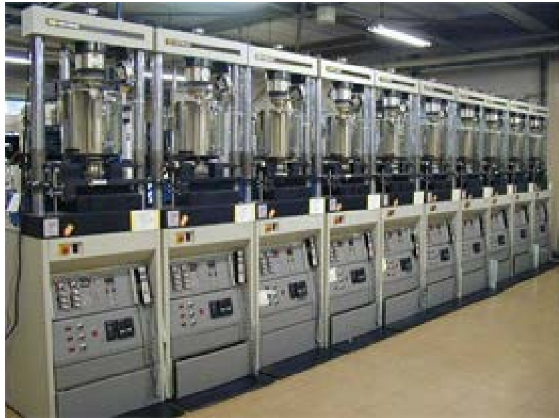
クリープ疲労試験装置
