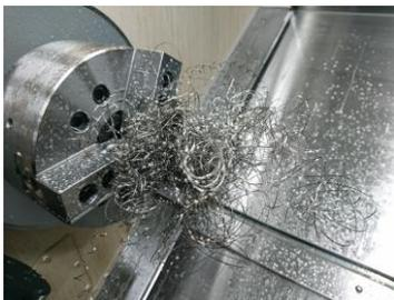
切削速度150m/min以上: 治具に切り屑が絡まる
