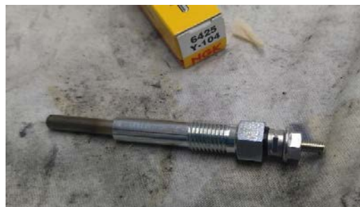
図2 グローブプラグ (日本特殊陶業製 Y-104) なお、このグローブプラグの定格電圧は 10.5 V であり、
