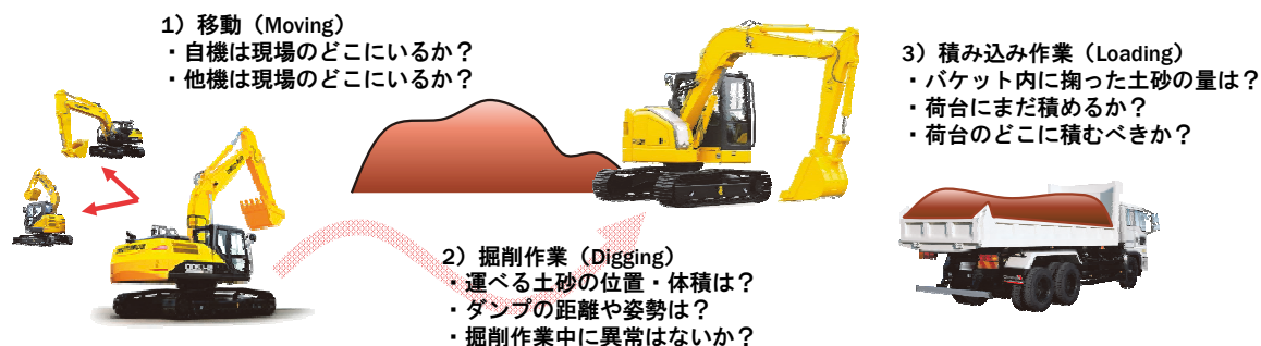
図1 : 造成現場における複数建機の協調作業
