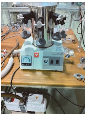
図3. フリーズドライサンプル作製のための実験装置
