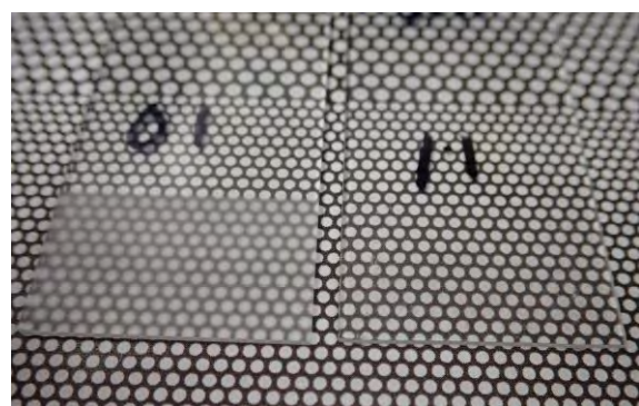
図2 処理前(左)と熱処理後(右)のガラスの外観の変化
