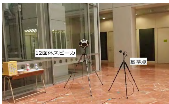
写真 3 7号館ロビーにおける測定 (12面体スピーカと基準点)
