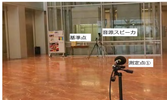
写真 4 7号館ロビーにおける測定 (アナウンス用スピーカと測定点)
