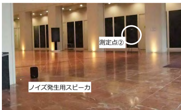
写真 3 7号館ロビーにおける測定 (12面体スピーカと基準点)
