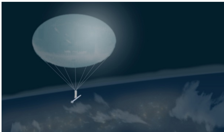
地球観測システムや通信システムといった人工衛星を利用するための打ち上げサービスとして、高度30km付近の成層圏からロケットの発射を提案
