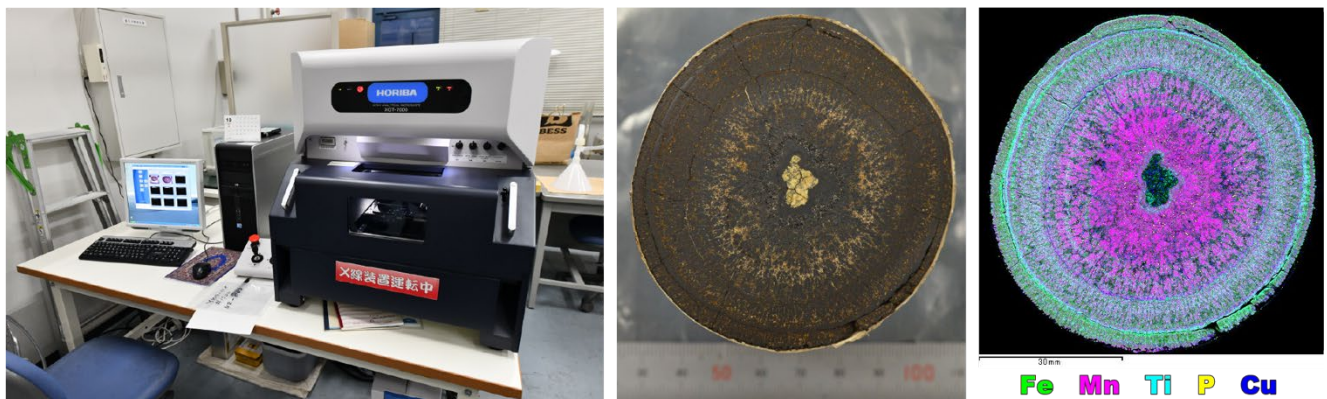
図3. 微小領域蛍光X線分析装置とマンガンノジュールの分析例(図2下に示したものと同一試料)
