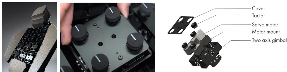
「TorsionCrowds」：2軸ジンバル機構により支持された接触刺激デバイス
