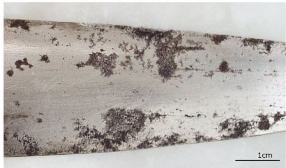
図 1 ツタンカーメンの鉄剣の画像。(a)(b) 2020 年 2 月に我々が鉄剣の両面を撮像したもの。(c) 1925 年発掘時に鉄剣の片面(a)を Harry Burton 氏が撮影したもの。オックスフォード大学グリフィス研究所の許可を得て複製した画像。(d) 鉄剣の面(a)の拡大写真。中央を横切るひび割れと鉄剣の長手方向に平行に走る細かい擦り傷。(e) 鉄剣の面(a)の拡大写真。所々斑点状に分布する黒い部分は硫化鉄。
