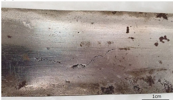
図 1 ツタンカーメンの鉄剣の画像。(a)(b) 2020 年 2 月に我々が鉄剣の両面を撮像したもの。(c) 1925 年発掘時に鉄剣の片面(a)を Harry Burton 氏が撮影したもの。オックスフォード大学グリフィス研究所の許可を得て複製した画像。(d) 鉄剣の面(a)の拡大写真。中央を横切るひび割れと鉄剣の長手方向に平行に走る細かい擦り傷。(e) 鉄剣の面(a)の拡大写真。所々斑点状に分布する黒い部分は硫化鉄。
