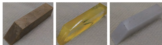
図2 燃料 (LT, HTPB, パラフィンワックス)
