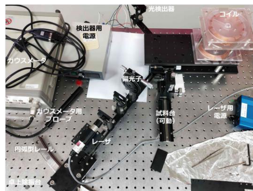
図1 当研究室に構築した磁気 Kerr 効果測定装置
