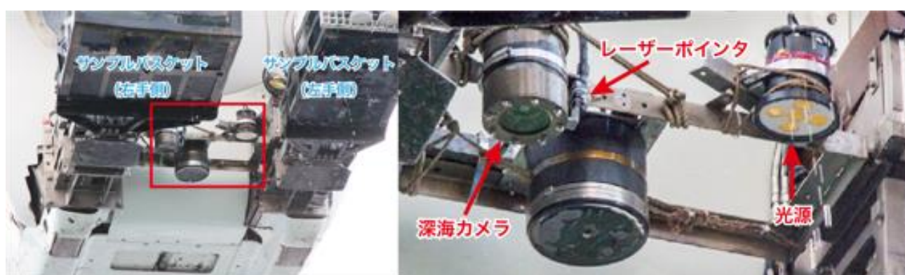
補足 5：「しんかい 6500」に取り付けた 4K 深海カメラ（耐圧容器内に格納されている）と光源。吊り上げられた「しんかい 6500」を正面下から撮影。
