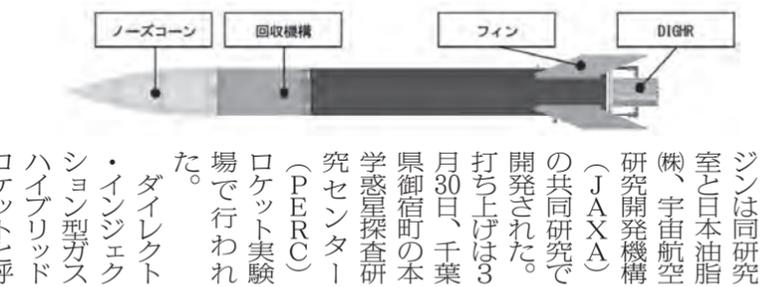
ジンとは同研究室と日本油脂(株)、宇宙航空研究開発機構(JAXA)の共同研究で開発された。打ち上げは3月30日、千葉県御宿町の本学惑星探査研究センター(PERC) ロケット実験場で行われた。 ダイレクト・インジェクション型ガスハイブリッドロケットと呼ばれるこのエンジンは、燃料に「それ自体が発熱しながら、分解してガスになるエネルギー」を持った「グリニル・アジド・ポリマー」(GAP)を使っている。火薬を使わないため極めて安全な上に燃焼効率が高い。 また、GAPガスの
