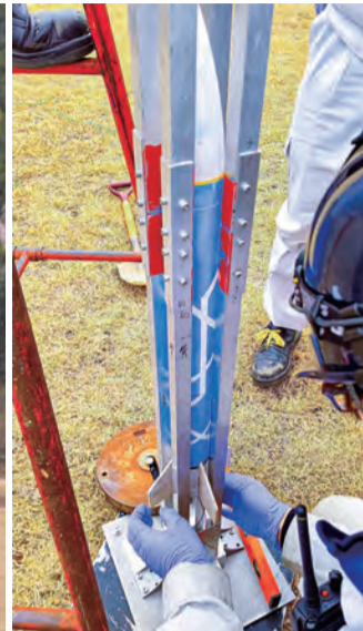
④ロケットに新開発の推進薬を装填し発射準備 ⑤燃焼実験を開始
