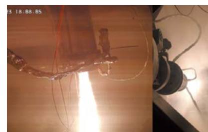
推力方向制御装置を用いた燃焼試験の様子
